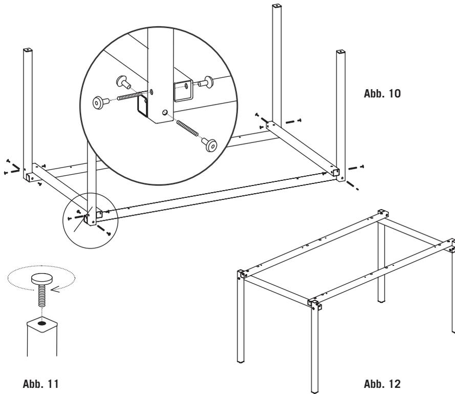
Die Tischbeine ebenfalls Loch über Loch in den Ecken einfügen und mit jeweils zwei Gewindestangen und vier Rundmuttern verbinden (Abb. 10). Stellfüße in die Gewindestopfen der Tischbeine eindrehen (Abb. 11). Tischgestell umdrehen und alle Rundmuttern abschließend nochmals fest anziehen. ERIK NIRO ist fertig montiert (Abb. 12). Tisch mithilfe der Stellfüße am Platz ausrichten. Optional die kleinen Durchgangslöcher in den langen Querrohren zur Befestigung von Tischplatten nutzen.
