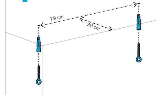
Bohrungen in einem Abstand von 79 cm zueinander und mindestens 30 cm von der Wand entfernt bohren. Universaldübel einsetzen und die Augenschraube einschrauben.
