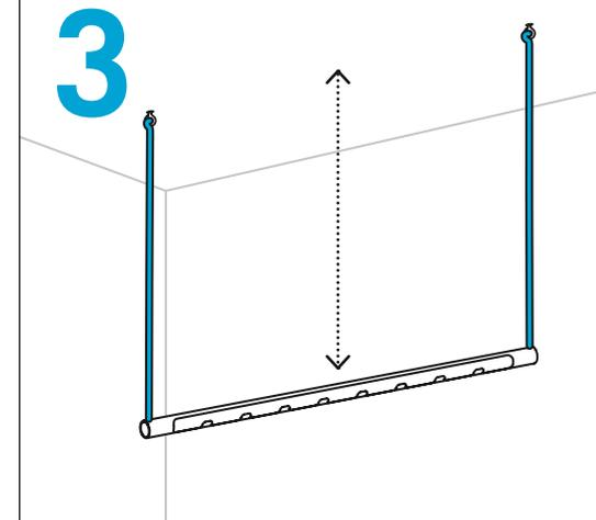
Die Seilenden Seite für Seite durch die Augenschrauben fädeln, gewünschte Höhe einstellen und anschließend mit einem Knoten je Seite fixieren. Die Garderobe kann maximal 2 m von der Decke abgehängt werden.
