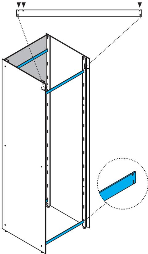
Setzen Sie nun die ersten vier Fachbodenträger ein, indem Sie diese auf einer Seite des Pfostens in die länglichen Aussparungen bis zum Anstoß einstecken. Nun auch die andere Seite des Trägers in die gegenüberliegende Aussparung einfügen. Die beiden unteren Schlitz des Bodenträgers müssen im Pfosten einrasten und fest sitzen.
