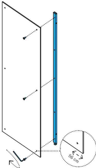
Die zweite Seitenwand mit dem zweiten vorderen Pfosten „X“ verschrauben (wie in Schritt 4). In dem abgebildeten Beispiel öffnet die Tür nach rechts.
