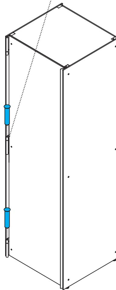
Die beiden Einsteckbolzen in die unteren Scharniere stecken. Abschließend prüfen, ob die Tür gleichmäßig schließt und von den Magneten geschlossen gehalten wird. Gegebenenfalls sollte der Schrank mit einer Wasserwaage nachjustiert werden (siehe Schritt 9). Dabei sollte die Tür geschlossen sein. Für eine einfachere Nachjustierung und leichteren Zugriff auf die Stellfüße kann der unterste Einlegeboden entfernt werden.
