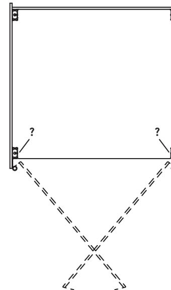
Damit es bei der weiteren Montage nicht zu Fehlern kommt, ist es hilfreich, zuerst in der Zeichnung die spätere Position der Türen einzuzichnen bzw. zu vermerken, auf welcher Seite der Pfosten mit den Magneten „M“ montiert wird.
