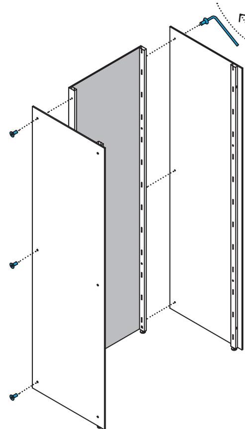
Anschließend die beiden Seitenwände an die Pfosten der Rückwand schrauben.
