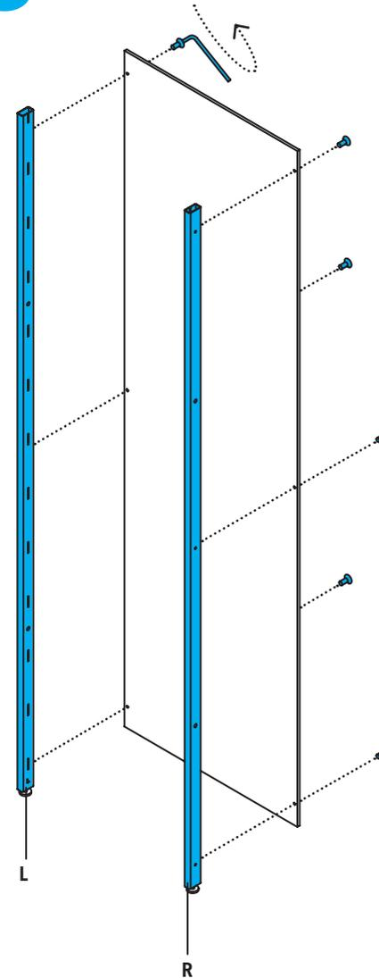
Die Rückwand mit dem rechten „R“ und dem linken „L“ hinteren Pfosten verschrauben. Die geschlitzten Seiten der Pfosten weisen dabei nach innen. Die Bohrungen der Rückwand sind einseitig gesenkt, um die Schraubenköpfe aufzunehmen. Die Pfosten an der Gegenseite ansetzen.
