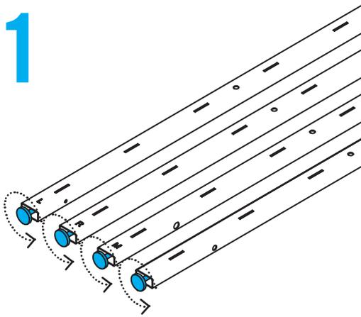
Zunächst bei allen 4 Rohren die Stellfüße etwa 1 cm weit ausdrehen.
