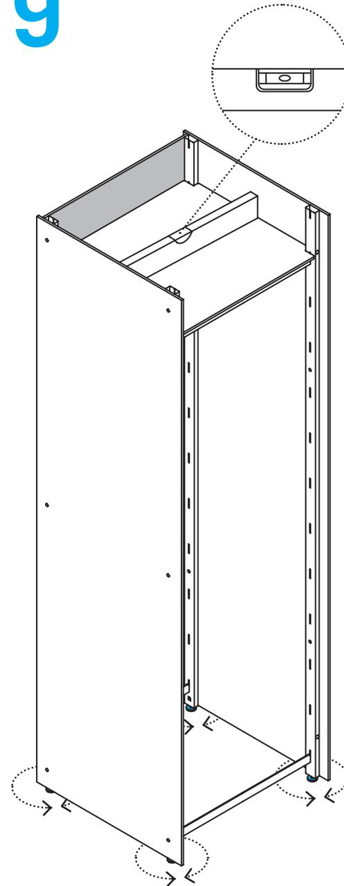
Der Schrank sollte nun final positioniert werden. Die Konstruktion mit einer Wasserwaage und unter Justierung der Stellfüße ausrichten.
