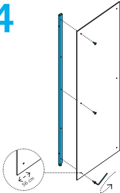
Die Seitenwand mit einem der vorderen Pfosten verschrauben. Hier zunächst noch einmal überprüfen, in welche Richtung die Tür später geöffnet werden soll bzw. auf welcher Seite der Pfosten mit den Magneten „M“ montiert wird (siehe Skizze „Vorbereitung“).
