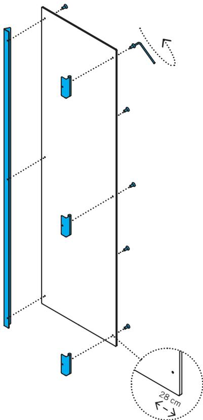
Die Scharniere für das Türblatt und die Griffleiste mit dem Türblatt verschrauben. Die Bohrungen im Türblatt sind frontseitig gesenkt, um die Schraubenköpfe aufzunehmen. Griffleiste und Scharniere an der Rückseite ansetzen.
