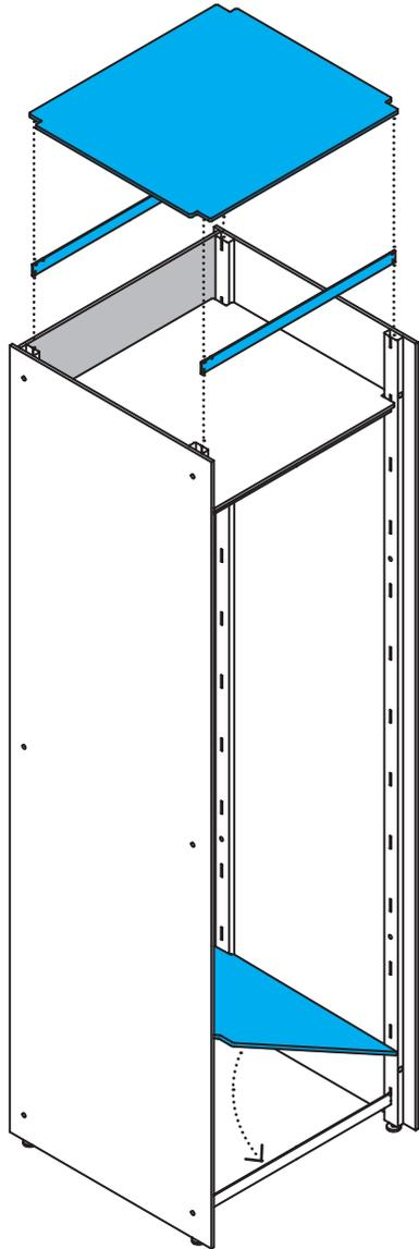
Die oberen Fachbodenträger und den Deckel einsetzen.
