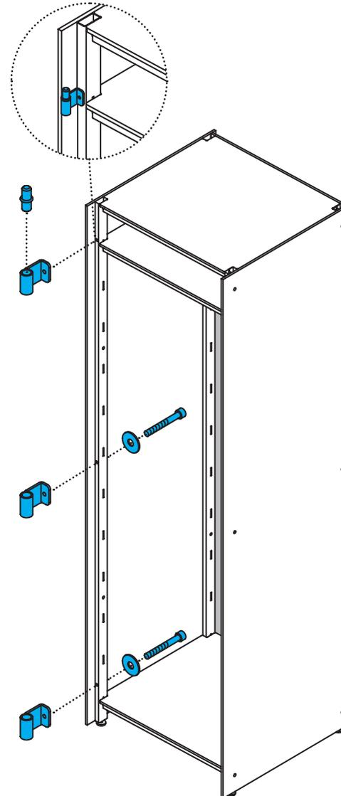
Die Scharniere für die Tür in die entsprechenden Bohrungen des vorderen Pfostens montieren. Dazu die Schrauben mit Unterlegscheibe von innen durch die Bohrungen im Pfosten stecken und das Scharnier außen anschrauben. In das oberste Scharnier den Doppelbolzen einstecken.
