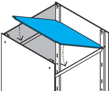
Zur Stabilisierung einen Fachboden oben einsetzen. Den untersten Boden noch nicht einsetzen, damit die Stellfüße gut erreichbar bleiben.
