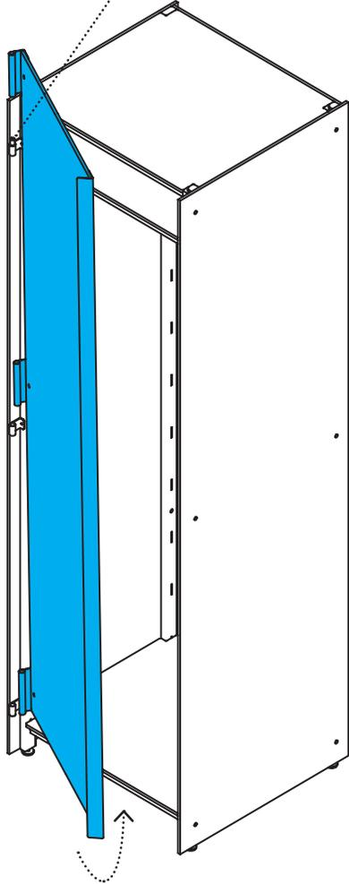
Die Tür auf den Doppelbolzen aufsetzen. Die Tür dabei unten leicht zur Seite schwenken, damit sie nicht auf den unteren beiden am Pfosten montierten Angeln aufsetzt.
