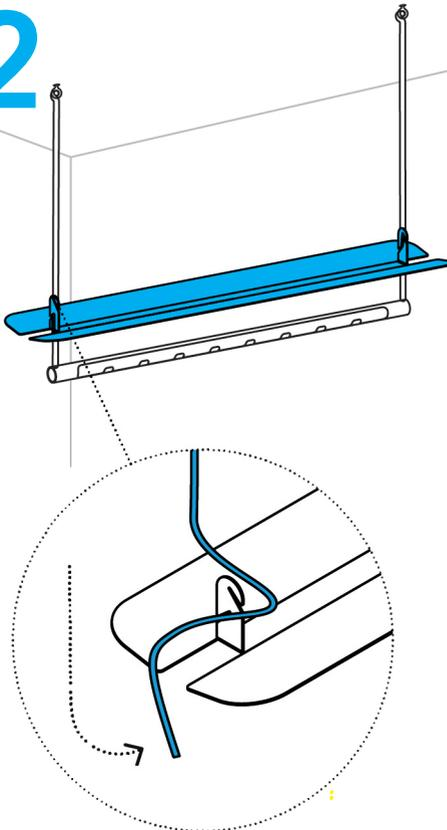
Die Ablage an der gewünschten Höhe positionieren, das Seil durch die Laschen fädeln und in die Einschnitte im Rohr klemmen.
