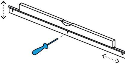
Dübel einstecken, die Wandschiene mit der abgekanteten Seite nach oben positionieren und mit drei Schrauben an der Wand montieren. Mithilfe der Langlöcher horizontal ausrichten.
