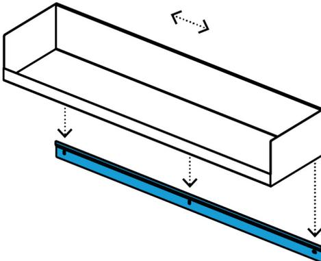
Das Regal vorsichtig von oben in die Wandschiene schieben und horizontal auf der Schiene ausrichten.
