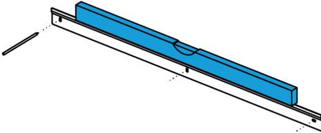
Mithilfe der Wandschiene als Schablone und einer Wasserwaage die Bohrlöcher anzeichnen.
