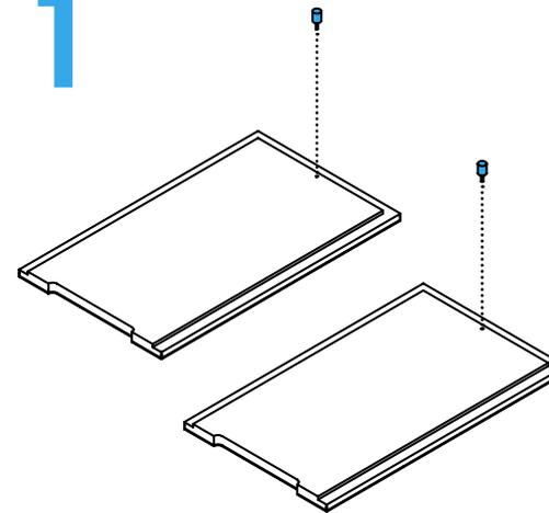
Die beiden Gummipuffer in die Gewindehülsen der beiden Deckel einschrauben.
